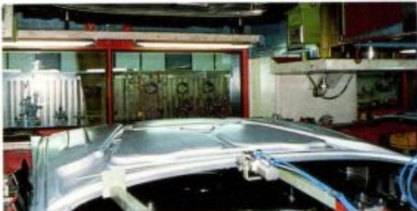
Hier werden die Karosserieteile geschweißt. Diese Arbeit wird von Robotern gemacht.
