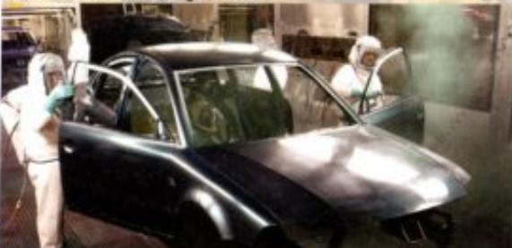
Jetzt werden die Karosserien lackiert. Jede Karosserie wird mehrere Male gespritzt. So wird sie gegen Rost geschützt.
