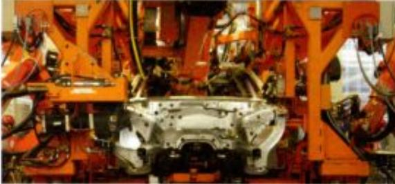
Danach werden die Blechteile zusammengeschweißt. Schwere Arbeit wird von Robotern gemacht.
