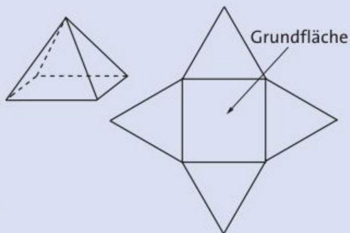
Um einen Körper anschaulich auf einem Blatt Papier darzustellen, wird oft das so genannte **Schrägbild** verwendet. Es ist das Ergebnis einer schiefwinkligen **Projektion**, bei der parallele Projektionsstrahlen schräg (in der Regel im  $45^\circ$ -Winkel) auf eine Ebene verlaufen. Man nennt diese Darstellung auch **Kavalierprojektion**.
